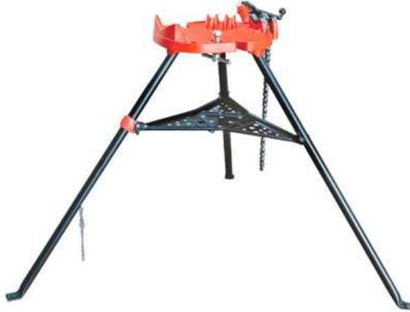
La mesa de trabajo o prensa tripode modelo H401 cuenta con mordazas y cadena de ajuste con tornillo de fijación para el tensado, con rango de medidas 1/2 a 6 pulgadas de diámetro, patas plegables y mango de transporte. Herramienta ideal para trabajos en Piping de todo tipo.
